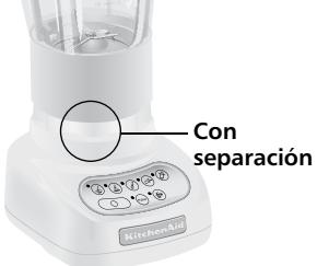
La jarra no está colocada correctamente en el collar de bloqueo, lo que impide el enganche de los acopladores. Retire la jarra de la base y colóquela correctamente en el collar. Presione hacia abajo y gire la jarra a la derecha en el collar de bloqueo hasta que oiga el segundo chasquido. Esto permitirá que la jarra enganche el acoplador. Consulte el apartado Montaje de la licuadora de la página 5.
