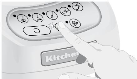
4. Seleccione un botón de velocidad. Manténgalo presionado durante el tiempo deseado. Los indicadores de los botones de velocidad e INTERMITENTE ( ) seguirán encendidos durante el intervalo en el que la licuadora funciona a la velocidad seleccionada. Cuando suelte el botón, la licuadora se detendrá, pero seguirá en modo INTERMITENTE ( ) y el indicador del modo INTERMITENTE ( ) volverá a parpadear.
