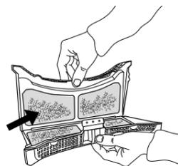
4. Das Filterfach mit einem weichen Tuch oder vorsichtig mit einem Staubsauger reinigen.
