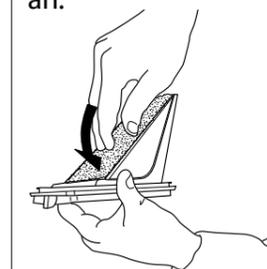
7. Reinigen Sie die Filterkammer des Trockners vorsichtig mit einem feuchten Tuch oder mit einem Staubsauger.
