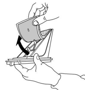
4. Reinigen Sie den Filterschaumstoff und den Filter von Hand oder unter fließendem Wasser. Waschen Sie den Filterschaumstoff nicht in der Waschmaschine.
