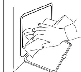
**8.** Bodenfilter wieder einsetzen. Sicherstellen, dass er komplett in das Filterfach eingesetzt ist.
