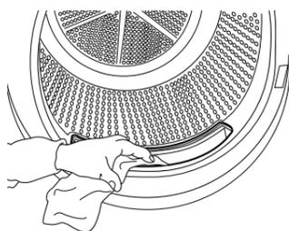
5. Schließen Sie den Filter und setzen Sie ihn in der richtigen Richtung ein, so dass er vollständig in das Filterfach integriert ist.
