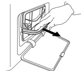
3. Entfernen Sie den Schaumstoff aus dem Bodenfilter, um ihn zu reinigen.
