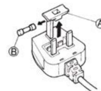
1. Sicherungsdeckel (A) entfernen und Sicherung (B) herausnehmen.
