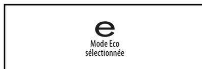
**LORSQUE LA FONCTION ÉCO EST ACTIVÉE**, l'intensité de l'affichage s'atténue automatiquement au bout d'un certain temps pour économiser l'énergie. Elle est automatiquement rétablie lorsqu'une touche est enfoncée ou que la porte est ouverte.
