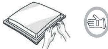
Coloque la placa en la abertura realizada en la encimera respetando las dimensiones indicadas en las instrucciones de instalación.
