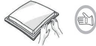
Installez la table de cuisson dans l'ouverture du plan de cuisson dont les dimensions correspondent à celles figurant dans le mode d'emploi.
