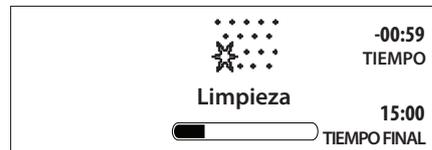
Cuando termine el ciclo, un mensaje parpadeará en la pantalla. Se indicará la temperatura residual en la pantalla y la puerta permanecerá bloqueada hasta que la temperatura del interior del horno retorne a un nivel seguro.
