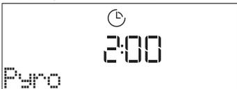
Appuyez sur  $+$  ou  $-$  pour sélectionner le cycle souhaité, puis appuyez sur  $\checkmark$  pour confirmer. Une fois qu'un cycle a été sélectionné, si vous le souhaitez, appuyez sur  $+$  ou  $-$  pour régler l'heure de fin (départ différé), puis appuyez sur  $\checkmark$  pour confirmer. Nettoyez la porte et enlevez tous les accessoires
