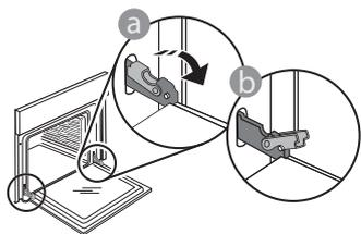
2. Fermez le plus possible la porte. Tenez la porte fermement avec les deux mains, ne la tenez pas par la poignée. Enlevez simplement la porte en continuant à la fermer tout en la tirant vers le haut en même temps jusqu'à ce qu'elle se décroche de son logement. Placez la porte sur un côté, en l'appuyant sur une surface douce.
