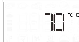
Nyomja meg a gombot a beállításokhoz. Forgassa el a beállítógombot a hússzonda célhőmérsékletének beállításához. Nyomja meg a gombot a jóváhagyáshoz.
