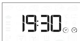
Lūdzu, nemiņiet vērā: lestatot aizkavētu gatavošanas sākuma laiku, tiks atspējota priekšsildīšanas fāze. Krāsns pamazām sasniegas jūsu norādīto temperatūru, kas nozīmē, ka gatavošanas laiks būs ilgāks nekā norādīts gatavošanas tabulā.
