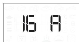
Sukdami pasirinkimo rankenelę pasirinkite nominalią srovę, tada paspauskite ir patvirtinkite.
