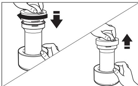
**8** Tenez le couvercle de l'infuseur d'une main et retenez le socle de l'autre main. Placez le couvercle sur l'infuseur en le tournant et en appuyant légèrement. Puis, à l'aide de la poignée, tirez l'infuseur et son couvercle hors du socle.
