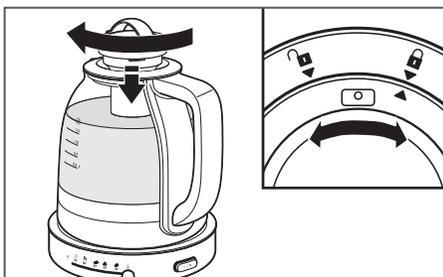
**9** Placez l'infuseur et son couvercle dans le couvercle de la bouilloire. Tournez la poignée pour verrouiller le couvercle de l'infuseur sur celui de la bouilloire. Pour savoir s'il est bien verrouillé, vérifiez que l'indicateur du couvercle de l'infuseur est aligné avec l'indicateur du symbole verrouillage sur le couvercle de la bouilloire.
