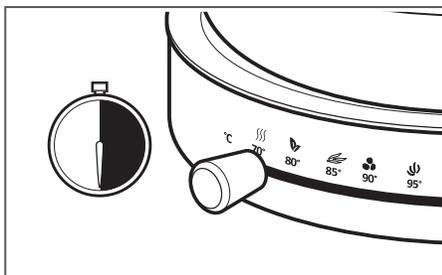
**13** Après avoir atteint la température demandée, la bouilloire passe automatiquement en mode Maintien au chaud (70 °C) pendant 30 minutes. La lumière autour du bouton I/O reste allumée lorsque la bouilloire-théière 2en1 est en mode Maintien au chaud. Si vous retirez la bouilloire, faites glisser le bouton de sélection de la température sur 70 °C et appuyez de nouveau sur le bouton I/O pour la garder chaude lorsque vous la replacez sur la base.
