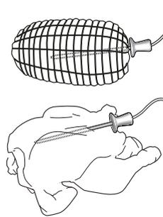
Es muy importante colocar la sonda con precisión para obtener resultados de cocción óptimos. Introduzca la sonda completamente en la parte más carnosa, evitando huesos y zonas de grasa. En el caso de las aves, la sonda debería introducirse de forma transversal, en el centro de la pechuga, asegurándose de que la punta no termine en una zona hueca. En el caso de carnes con
