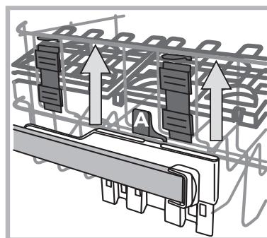
Když je koš vybaven systémem Lift-Up\* (viz obrázek), zvedněte koš po jeho uchopení na bocích a pohněte jím směrem nahoru. Pro návrat do spodní polohy stiskněte páky (A) na bocích koše a doprovodte jej při sestupu směrem dolů.
