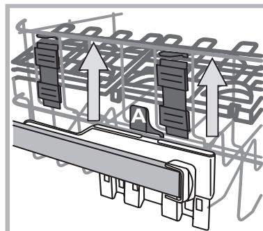
Если корзина оснащена Lift-Up\* (см. схему), поднимите корзину, взявшись за нее с боков и переместив ее вверх. Для опускания корзины вниз нажмите на рычажки (A) с боков корзины и направьте корзину вниз.
