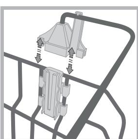
Horní koš je výškově nastavitelný dle potřeby: do horní polohy kvůli umístění neskladného nádobí; do spodní polohy kvůli využití prostoru sklopních nebo naklonitelných držáků a vytvoření většího prostoru směrem nahoru.
