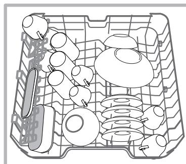
Některé modely myček nádobí disponují naklonitelnými částmi\*, které lze použít ve svislé poloze k uložení čajových nebo dezertových talířů nebo spuštěné dolů k uložení misek a nádob na potraviny.
