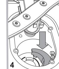
Після очищення фільтрів правильно встановіть фільтрувальний вузол на місце; це важливо для належної роботи посудомийної машини.
