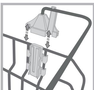
Перед загрузкой лотка проверьте, чтобы крепления были прочно прикреплены к верхней корзине. (см. схему)
