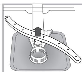
Demontáž spodního ostříkovacího ramena se provádí stisknutím jazýčků, nacházejících se po stranách, směrem nahoru.
