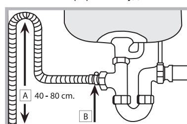
Перед подсоединением сливного шланга к сифону мойки снимите пластиковую пробку (B).
