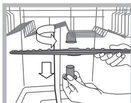
Щоб зняти верхній розпилювач, слід розгвинтити проти годинникової стрілки пластмасову круглу гайку. При встановленні верхнього розпилювача поверніть догори частину з більшою кількістю отворів.
