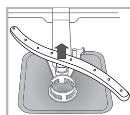
Pentru a demonta stropitorul inferior, apăsați cele două clapete laterale și trageți stropitorul în sus.
