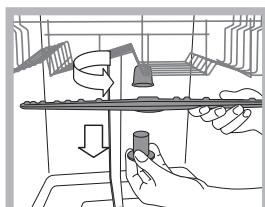
Demontáž horního ostříkovacího ramena vyžaduje odšroubování plastové kruhové matice proti směru hodinových ručiček. Horní ostříkovací rameno je třeba namontovat tak, aby bylo obráceno otvory směrem nahoru.
