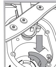
Po vyčistení filtrov namontujte filtračnú jednotku naspäť a umiestnite ju správne do jej uloženia; je to nevyhnutné pre správnu činnosť umývačky.
