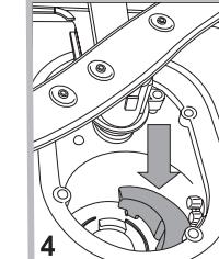
După curățarea filtrelor, montați din nou grupul de filtrare și așezați-l corect în locașul său; este extrem de important pentru o bună funcționare a mașinii de spălat vase.
