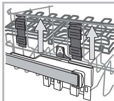
Dacă coșul este prevăzut cu **Lift-Up\*** (vezi figura), ridicați coșul prințându-l din părțile laterale și mișcați-l în sus. Pentru a reveni la poziția joasă, apăsați pârghile (A) din părțile laterale ale coșului și urmați coborârea.
