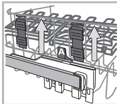
Якщо короб оснащений системою Lift-Up\* (див.малюнок), візьміться за нього з боків і потягніть вгору для підйому. Щоб повернутися у нижнє положення, натисніть на важіль (A) з боків коробу і притримайте його під час опускання.
