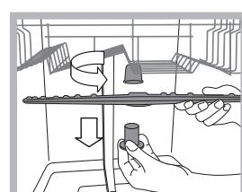
Pentru demontarea stropitorului superior, rotiți piulița din plastic în sens invers acelor de ceasornic. Stropitorul superior trebuie remontat cu partea care are cel mai mare număr de orificii orientată în sus.
