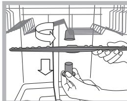
Demontáž horného ostrekovacieho ramena vyžaduje odskrutkovanie plastovej kruhovej matice proti smeru hodinových ručičiek. Horné ostrekovanie rameno je potrebné namontovať späť tak, aby bolo obrátené väčším počtom otvorov smerom nahor.
