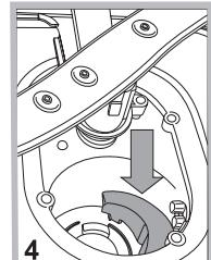
Po vyčištění filtrů provedte zpětnou montáž filtrační jednotky a její správné umístění do jejího uložení; představuje nezbytný předpoklad správné činnosti myčky.
