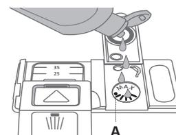
1. Ouvrez le distributeur **B** en appuyant et en tirant sur la languette sur le couvercle.
