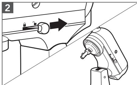
**2** Desbloquee y levante la cabeza del motor. A continuación, bloquee\*\* la cabeza para que quede levantado.
