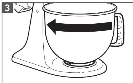
**3** Coloque el recipiente en la placa de sujeción del recipiente. Gire suavemente el recipiente hacia la derecha.
