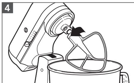
**4** Para retirar el accesorio: repita los pasos 1 y 2. Presione el accesorio hacia arriba todo lo que pueda y gírelo a la izquierda. A continuación, retire el accesorio del eje del batidor.
