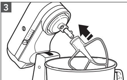
**3** Deslice el accesorio en el eje del batidor y empújelo hacia arriba todo lo que pueda. A continuación, gire el accesorio hacia la derecha, enganchándolo sobre la clavija del eje.
