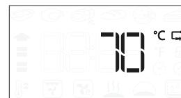
Pokud dojde k připojení teploměru v průběhu výběru funkce, přepne se displej na výchozí cílovou teplotu pro teploměr do masa.
