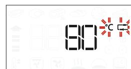
Otáčaním gombíka nastavte teplotu priestoru rúry. Stlačením alebo potvrďte a spustite cyklus prípravy jedla.
