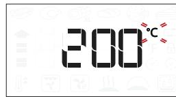
Jeżeli na ekranie migają ikonki °C/°F, zmienić wartość za pomocą pokrętła, a następnie wcisnąć , aby zatwierdzić wybór i kontynuować zmianę ustawień kolejnych parametrów (o ile to możliwe).
