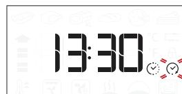
Tarpeen vaatiessa aseta kypsennyksen haluttu päättymisaika nupia käänämällä, vahvista sitten painamalla ja käynnistä toiminto. Laita ruoka uuniin ja sulje luukku: Toiminto käynnistyy automaattisesti sen jälkeen, kun on kulunut laskettu aika, joka tarvitaan siihen, että kypsennys päättyy asetettuna ajankohtana.
