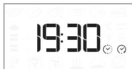
Napominjemo: Programiranje odgode pokretanja kuhanja onemogućuje fazu zagrijavanja pećnice. Pećnica će postupno doseći potrebnu temperaturu što znači da će vrijeme kuhanja biti malo dulje od onog navedenog u tablici kuhanja.
