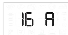
Forgassa el a gombot a névleges áramerősség kiválasztásához, majd nyomja meg a gombot a megerősítéshez.
