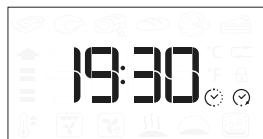
Observera: När en födröjd start programmeras avaktiveras ugnens förvarmningsfas. Ugnen kommer att uppnå önskad temperatur gradvis, vilket betyder att tillagningstiderna är något längre än de som listas i tillagningstabellen.
