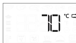
Dersom steketermometeret er koblet til mens det velges en funksjon, bytter displayet til standard ønsket temperatur for steketermometeret.
