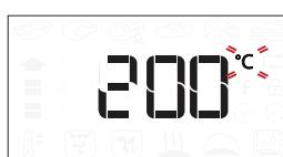
Wenn die Symbole °C/F auf dem Display blinken, den Knopf drehen, um den Wert zu ändern, anschließend zur Bestätigung drücken und fortfahren, um die nachfolgenden Einstellungen zu ändern (falls möglich).
