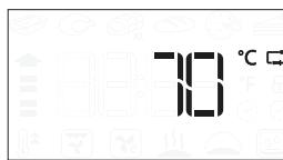
Als de gaarthermometer wordt aangesloten tijdens de selectie van een functie, schakelt het display over naar de voorgeprogrammeerde doeltemperatuur van de gaarthermometer.
