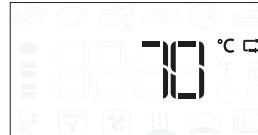
Ако сондата за месо е включена по време на избиране на функция, дисплеят се превключва на целевата температура на сондата за месо по подразбиране.
