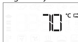
Wenn der Kerntemperaturföhrer während der Auswahl einer Funktion eingesteckt wird, wechselt das Display zur Standard-Zieltemperatur des Kerntemperaturföhrers.
