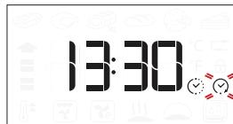
V prípade potreby otáčaním nastavovacieho ovládača nastavte želaný čas ukončenia pečenia, potvrďte stlačením a spusťte funkciu.
