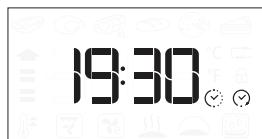
Merk: Ved å programmere en utsatt start for steiking vil en alltid utelukke fasen for forvarming av ovnen. Ovnen vil gradvis nå temperaturen du ønsker, dette betyr at steketiden blir noe lengre enn det som vises i tilberedningstabellen.
