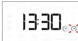
Dacă este necesar, rotiți butonul pentru a seta ora la care dorîți să se finalizeze procesul de preparare, apoi apăsați pentru a confirma și a porni funcția. Introduceți alimentele în cuptor și închideți ușa: Funcția va porni automat după calcularea perioadei de timp necesară pentru finalizarea preparării la ora setată.
