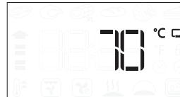
Ha a hússzondát egy funkció kiválasztása közben csatlakoztatja, a kijelző átvált az alapértelmezett hússzonda célhőmérsékletre.
