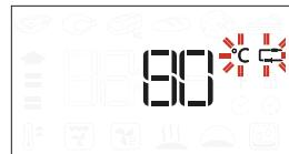
Pöörake nuppu ahju temperatuuri seadmiseks. Kinnitamiseks ja küpsetustüslikli käivitamiseks vajutage nuppu või .
