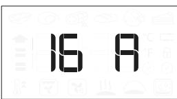
Sukdami pasirinkimo rankenėlę pasirinkite nominalią srovę, tada paspauskite ir patvirtinkite.
