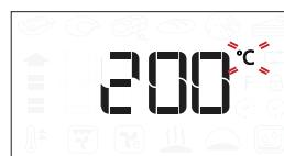
Keď na displeji bliká ikonka °C/°F, otáčaním gombíka zmeňte hodnotu, potvrdte stlačením a pokračujte zmenou ďalších nastavení (ak je to možné).
