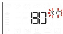
Rotiți selectorul pentru a seta temperatura cavității cuptorului.
