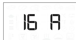
Otočením ovládacího knoflíku zvolte hodnotu jmenovitého proudu a následně pro potvrzení stiskněte .
