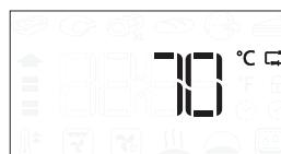
Jeżeli sonda do mięsa zostanie podłączona podczas wyboru funkcji, wyświetlacz przełączy się na domyślną docelową temperaturę sondy do mięsa. Nacisnąć , aby rozpocząć ustawianie. Obrócić pokrętło, aby ustawić docelową temperaturę sondy do mięsa. Nacisnąć , aby potwierdzić.
