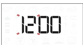
Števki za uro začneta utripati. Z obračanjem gumba nastavite uro in pritisnite za potrditev.
