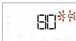
Vrid på ratten för att ställa in önskad ugnstemperatur. Tryck på eller för att bekräfta och starta tillagningsprogrammet.
