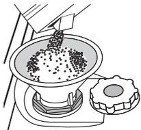
1. Togliere il cestello inferiore e svitare il tappo del serbatoio (ruotare in senso antiorario).
