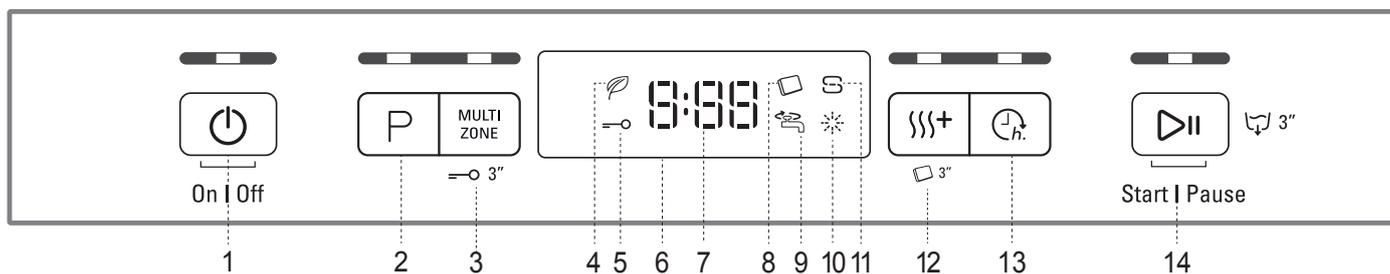
1. Ein-Aus/Reset Taste mit Anzeigelicht
