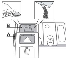
1. Hinsichtlich der Dosierung verweisen wir auf die zuvor erwähnte Information, in der die richtige Menge angegeben ist. Im Fach **B** sind Anzeigen die bei der Spülmitteldosierung helfen.
