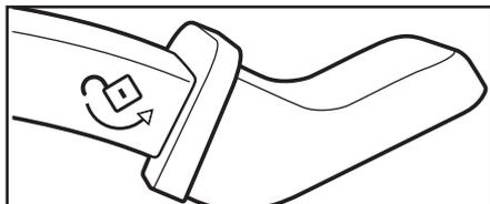
**IMPORTANT** : l'appareil ne se met pas en marche si le levier de verrouillage n'est pas verrouillé
