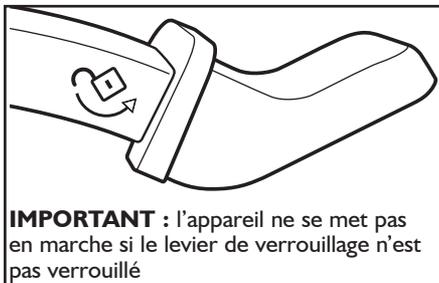
**IMPORTANT** : l'appareil ne se met pas en marche si le levier de verrouillage n'est pas verrouillé
