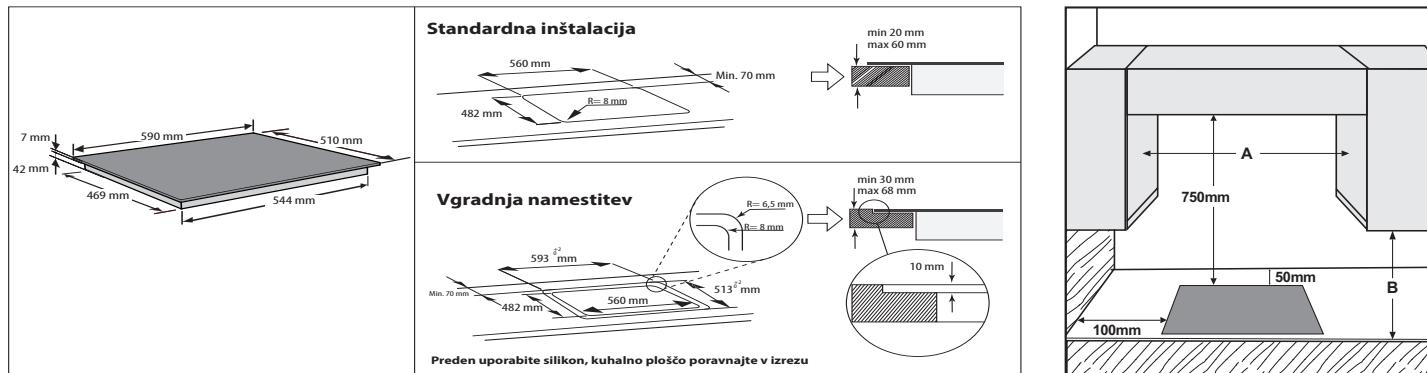
**OPOMBA:** Če je razdalja »A« med stenskimi elementi med 600mm in 730 mm, mora biti višina »B« najmanj 530 mm. Če je razdalja »A« med stenskimi omaricami večja od širine kuhalne plošče, mora biti višina »B« najmanj 400 mm. Če nad kuhalno površino namestite napo, glejte navodila nape za ustrezno razdaljo.
