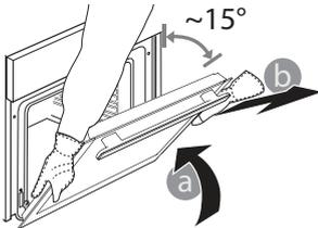
Réinstallez la porte en la plaçant devant le four pour aligner les crochets des charnières avec leurs appuis, et insérez la partie supérieure sur son appui.
