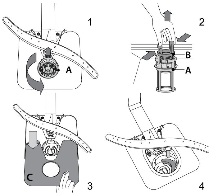
Nakon čišćenje filtera vratite sklop filtra i pravilno ga učvrstite na mjesto; to je važno za održavanje učinkovitog rada perilice suđa..
