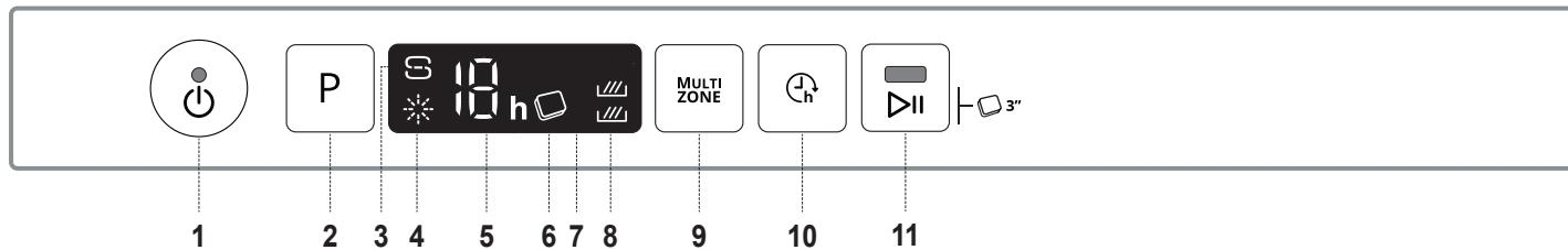
1. Tlačítko „zapnout-vypnout/vynulovat“ s kontrolkou
