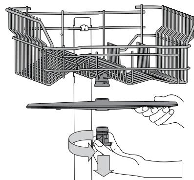
Horní ostřikovací rameno sejměte pootočením plastového upevňovacího kroužku proti směru hodinových ručiček. Horní rameno lze otočit tak, že jeho strana s větším množstvím otvorů směruje vzhůru.
