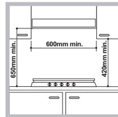
En cas d'installation de la table de cuisson sous un élément haut, ce dernier devra être monté à au moins 700 mm de distance du plan.
