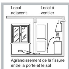
Ou, de manière indirecte depuis des locaux adjacents et équipés d'un conduit de ventilation avec l'extérieur comme susmentionné; ces locaux ne doivent pas être des parties communes du bâtiment, des chambres à coucher ou des locaux à risque d'incendie.
