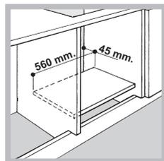
En cas d'installation au-dessus d'un four encastrable dépourvu de ventilation de refroidissement forcée, il faudra prévoir des prises d'air d'entrée et de sortie pour permettre une bonne aération à l'intérieur du meuble (voir figure).
