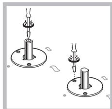
2. Déposez la manette et tournez la vis de réglage positionnée à l'intérieur ou sur le côté de la tige du robinet jusqu'à ce que vous obteniez une petite flamme régulière;
