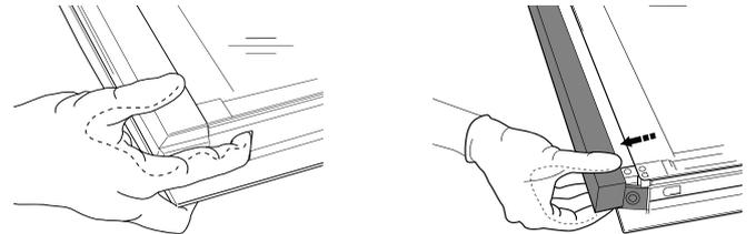
**2.** Sollevare e prendere saldamente il vetro interno con due mani, rimuoverlo e appoggiarlo su un piano morbido prima di eseguire la pulizia.
