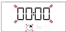
استخدم أو - لضبط مدة الطهي المرغوبة، ثم اضغط على للتأكد. قم بتشغيل الوظيفة عن طريق إدارة مفتاح الترموستات إلى درجة الحرارة المرغوبة. وستصدر إشارة صوتية وتشير وحدة العرض إلى اكمال الطهي.
