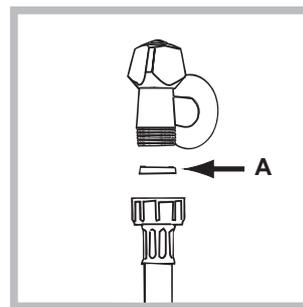
1. Вставьте прокладку А в конец заливного шланга и наверните его на вывод водопровода холодной воды с резьбовым отверстием 3/4 дюйма (см. рис.). Перед
