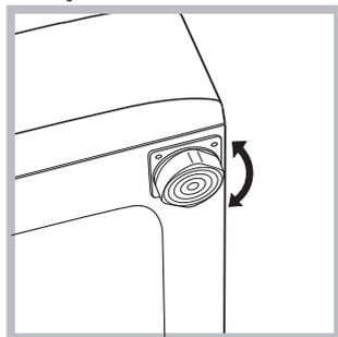
1. Установите стиральную машину на ровном и прочном полу, так чтобы она не касалась стен, мебели и прочих предметов.
