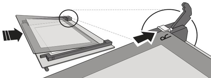
**4.** Зафиксируйте верхний край: Щелчок означает правильную установку. Перед установкой дверцы проверьте целостность уплотнения.
