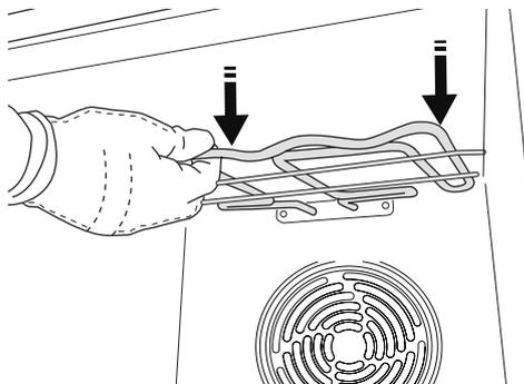
3. Чтобы вернуть нагревательный элемент в рабочее положение, поднимите и немного вытяните его на себя, а затем вставьте планку крепления в соответствующее гнездо.
