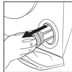
8. Limpiar el filtro de la bomba de drenaje: eliminar los residuos del filtro y limpiarlo bajo el agua corriente.
