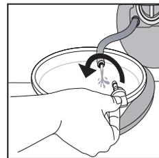
6. Girar el mango del filtro de salida y retirarlo del alojamiento. Cuando el recipiente esté lleno de agua, bloquear el extremo de la manguera y reintroducir la manguera en la base de la lavadora. Vaciar el recipiente. Bloquear firmemente la manguera de drenaje de emergencia.
