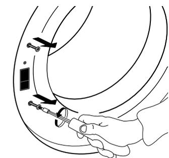
Recomendamos que as operações de remoção e fixação da porta sejam realizadas por duas pessoas. Certifique-se de que a máquina de secar está desligada. Abra a porta da máquina de secar.
