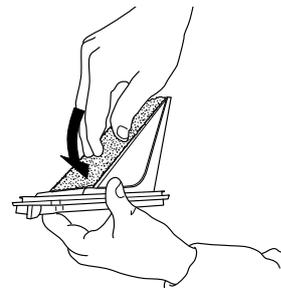
**7.** Limpe a câmara do filtro da máquina de secar com um pano húmido ou utilizando cuidadosamente um aspirador.
