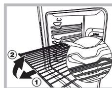
ATTENZIONE! Il forno è dotato di un sistema di arresto griglie che consente di estrarle senza che queste fuoriescano dal forno. (1) Per estrarre completamente le griglie e sufficiente, come indicato sul disegno, alzarle, prendendole dalla parte anteriore tirarle. (2)
