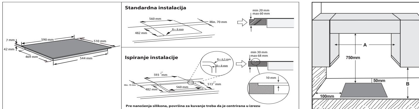
**NAPOMENA:** ako je razmak „A“ između strana elemenata od 600 do 730 mm, visina „B“ mora biti najmanje 530 mm. Ako je razmak „A“ između strana elemenata veći od širine ploče za kuvanje, visina „B“ mora biti najmanje 400 mm. U slučaju montaže aspiratora iznad površine za kuvanje, informacije o pravilnim razmacima potražite u uputstvu za aspirator.
