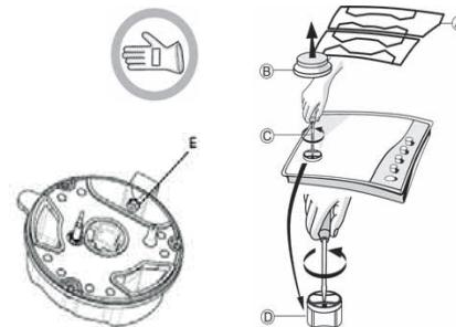
Pre montaže ploče za kuvanje pričvrstite pločicu za kalibraciju gase isporučenu zajedno sa injektorima na način da pokriva postojeće informacije u vezi sa kalibracijom gase.
