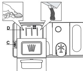
1. A mosogatószer kimérésekor a helyes mennyiség meghatározását az eddigi információk alapján végezze. A mosogatószeradagoló (**D**) belsejében elhelyezett jelzések segítenek a megfelelő mennyiség meghatározásában.
