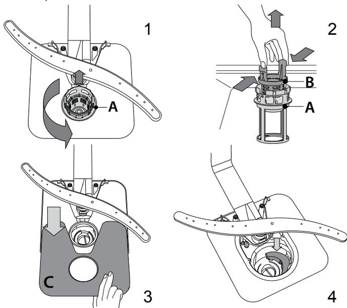
A szűrők tisztítása után helyezze vissza a szűrőegységet, és rögzítse megfelelően a helyére. Ez elengedhetetlen a mosogatógép hatékony működéséhez.
