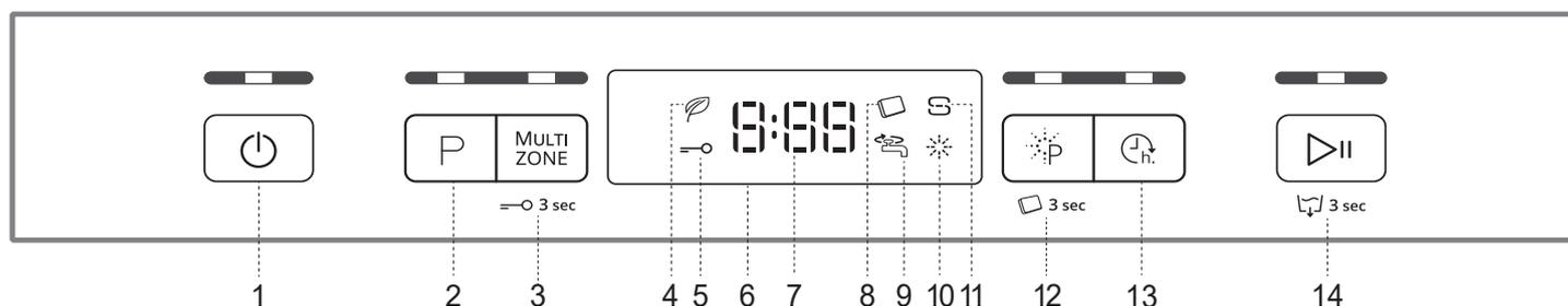
1. Ieslēgšanas-izslēgšanas/atiestatīšanas poga ar indikatora gaismiņu
