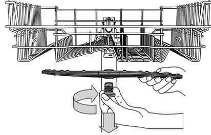
orní ostříkovačí rameno sejmete pootočením plastového upevňovacího kroužku ve směru pohybu hodinových ručiček.
