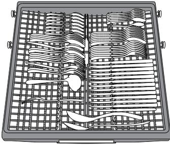
Trzecia półka-kosz jest przeznaczona do umieszczania sztućców. Sztućce należy wkładać tak, jak to pokazano na rysunku. Rozdzielone ułożenie sztućców ułatwia ich wyjmowanie po zmywaniu i zapewnia lepsze wysuszenie.
