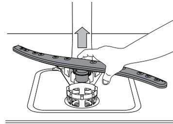
Spodní ostříkovačí rameno lze vyjmout zatažením směrem nahoru.
