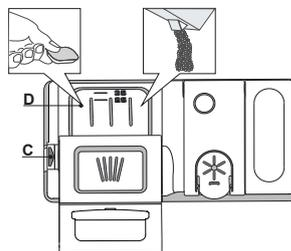
1. Nosakot mazgāšanas līdzekļa daudzumu, skatiet iepriekš minēto informāciju, lai pievienotu pareizu daudzumu līdzekļa. Dozatorā **D** ir norādes, lai pareizi dozētu mazgāšanas līdzekli.
