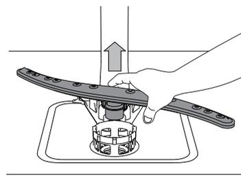
Brațul de pulverizare inferior poate fi demontat prin tragerea în sus.
