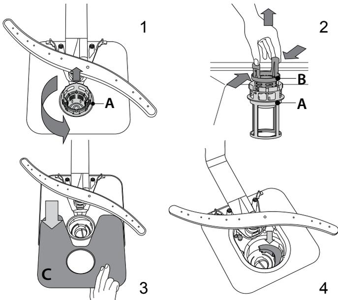
Pēc filtru iztīrīšanas novietojiet tos atpakaļ vietā un rūpīgi nostipriniet; tas ir svarīgi, lai saglabātu trauku mazgājamo mašīnas darbības efektivitāti.
