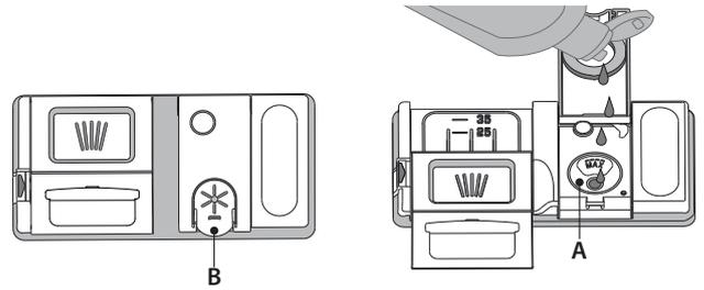
1. Deschideți dozatorul **B** apăsând și trăgând în sus clapeta de pe capac.
