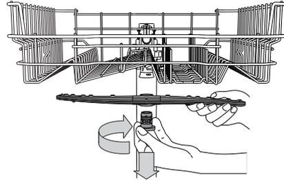
Lai noņemtu augšējo smidzināšanas sviru, pagrieziet plastmasas bloķēšanas gredzenu pulksteņrādītāja virzienā. Augšējā smidzināšanas svira jānovieto tā, lai puse, kurā ir lielākais skaits caurumu, būtu vērsta augšup.
