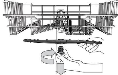
Aby zdjąć górne ramię natryskowe należy przekręcić plastikowy pierścień blokujący w kierunku ruchu wskazówek zegara. Górne ramię natryskowe powinno zostać z powrotem założone w taki sposób, aby strona z większą liczbą otworów była skierowana do góry.
