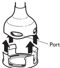
**REMARQUE :** veillez à ce que le protège-lame soit fixé avec les clips de montage positionnés entre les ports des embouts à lame.
