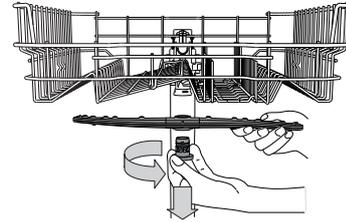
Para retirar o braço aspersor superior, rode o anel de bloqueio de plástico no sentido contrário ao dos ponteiros do relógio. O braço aspersor superior deve ser recolocado de modo a que o lado com mais orifícios fique voltado para cima.
