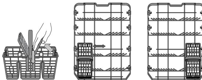
**Les couteaux et autres ustensiles avec des bords tranchants doivent être placés dans le panier à couvert avec la pointe vers le bas, ou placés à l'horizontale dans le compartiment rabattable sur le panier supérieur.**
