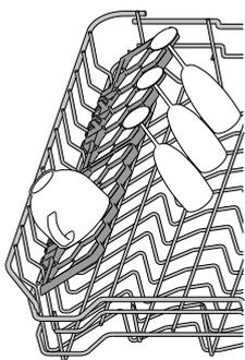
Les volets pliables latéraux peuvent être placés à trois hauteurs différentes pour optimiser le rangement de la vaisselle sur le panier. Les verres de vin peuvent être placés de façon sécuritaire dans les volets pliables en insérant le pied de chaque verre dans la fente correspondante.
