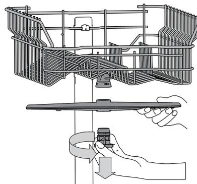
Pour enlever le bras d'aspersion supérieur, tournez l'anneau de verrouillage en plastique dans le sens antihoraire. Le bras d'aspersion supérieur doit être replacé de façon que le côté avec le plus grand nombre de trous est placé vers le haut.
