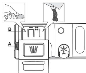
**Pour ouvrir le distributeur de détergent, utilisez le dispositif d'ouverture A. Insérez le détergent dans le distributeur sec B seulement. Placez la quantité de détergent pour le pré-lavage directement dans la cuve.**
