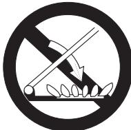
**ATENȚIE!** Capacul din sticlă se poate sparge dacă este încălzit. Stingeți toate arzătoarele sau eventualele plite electrice înainte de a-l închide.\*Se referă numai la modelele cu capac de sticlă arzătoarelor
