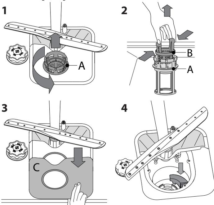
Una vez limpiados los filtros, recoloca el conjunto de filtrado y encájelo correctamente en su sitio; esto es esencial para garantizar el funcionamiento eficiente del lavavajillas.
