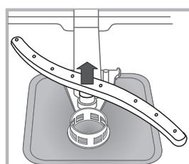
Demontáž spodního ostřikovacího ramena se provádí stisknutím jazyčků, nacházejících se po stranách, směrem nahoru.
