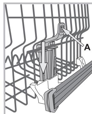
Als het rek beschikt over een **Lift-Up\*** (zie afbeelding), tilt u het rek op door het aan de zijkanten vast te houden. Til hem dan naar boven op. Om naar de lagere stand terug te keren, drukt u op de handels (**A**) aan de zijkanten van het rek en helpt u het rek weer naar beneden te gaan.
