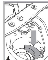
Après avoir nettoyé les filtres, remettre soigneusement le groupe filtrant à sa place, cette opération est fondamentale pour un bon fonctionnement du lave-vaisselle.
