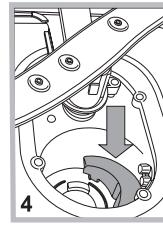
Po wyczyszczeniu filtrów należy ponownie zamontować zespół filtrujący i prawidłowo go umiejscowić; ma to zasadnicze znaczenie dla prawidłowego działania zmywarki.
