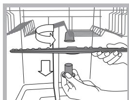
Demontáž horního ostřikovacího ramena vyžaduje odšroubování plastové kruhové matice proti směru hodinových ručiček. Horní ostřikovací rameno je třeba namontovat tak, aby bylo obráceno otvory směrem nahoru.
