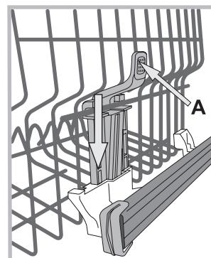
Když je koš vybaven systémem **Lift-Up\*** (viz obrázek), zvedněte koš po jeho uchopení na bocích a pohněte jím směrem nahoru. Pro návrat do spodní polohy stiskněte páky (A) na bocích koše a doprovodte jej při sestupu směrem dolů.
