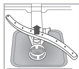
Pour démonter le bras de lavage inférieur, pousser sur les languettes situées sur les côtés et tirer vers le haut.
