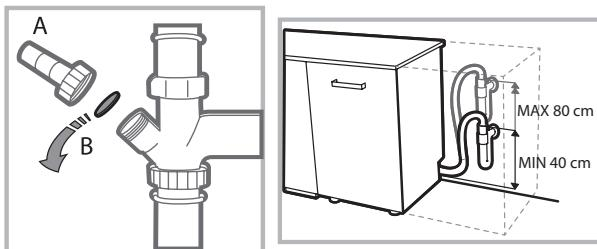
Avant de raccorder le tuyau d'évacuation de l'eau au siphon de l'évier, retirer le bouchon en plastique (B).
