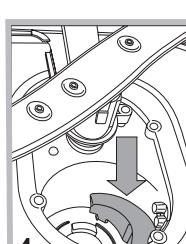
Po vyčištění filtrů provedte zpětnou montáž filtrační jednotky a její správné umístění do jejího uložení; představuje nezbytný předpoklad správné činnosti myčky.
