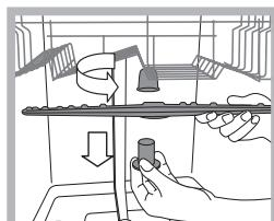
Aby zdemontować górny spryskiwacz, należy odkręcić plastikowy pierścień, obracając go w kierunku przeciwnym do ruchu wskazówek zegara. Górný zraszacz należy zamontować z otworami skierowanymi do góry.
