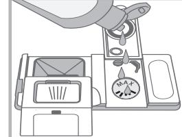
1. Open de houder “D” door het lipje op het deksel in te drukken en omhoog te halen.
