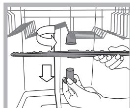
Pour démonter le bras supérieur, il faut dévisser sa bague en plastique en tournant dans le sens inverse des aiguilles d'une montre. Remonter le bras gicleur supérieur en veillant à ce que la face percée du plus grand nombre d'orifices soit bien orientée vers le haut.
