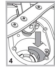
Na het reinigen van de filters dient u de filtergroep weer op zijn plaats te zetten. Dit is fundamenteel voor een goede werking van de afwasautomaat.
