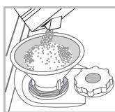
1. Wyjąć kosz dolny i odkręcić korek pojemnika, obracając go w kierunku przeciwnym do ruchu wskazówek zegara.
