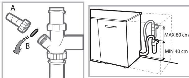
Voordat u de waterafvoerbuis aansluit op de sifon van de wasbak, moet u de plastic dop (B) verwijderen.
