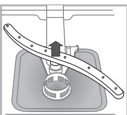
De onderste sproeiarm haalt u uit elkaar door druk uit te oefenen op de lipjes aan de zijkant en door hem daarna naar boven te trekken.
