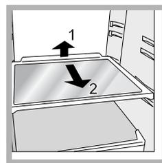
**BANDEJAS:** enteras o tipo rejilla. Son extraíbles y su altura es regulable gracias a las guías especiales (ver *la figura*), se utilizan para introducir recipientes o alimentos de gran tamaño. Para regular la altura no es necesario extraer las
