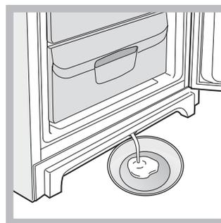
4. Certains de nos appareils sont équipés du SYSTEME DRAIN pour acheminer l'eau vers l'extérieur: laissez l'eau s'écouler dans un récipient (voir figure).
