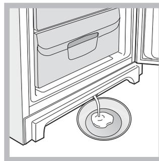
5. Anumite modele sunt dotate cu un sistem numit SISTEMA DRAIN care dirijează apa spre exterior. Așezați un recipient (vezi figura) pentru a recolta apa eliminată.
