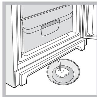
4. Alcuni apparecchi sono dotati del SISTEMA DRAIN per convogliare l'acqua all'esterno: lasciare che l'acqua defluisca in un contenitore (*vedi figura*).
