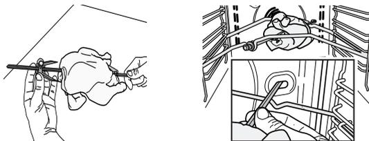
Nota: Per raccogliere i liquidi di cottura posizionare la leccarda al di sotto, aggiungendo 500 ml di acqua. Per evitare di scottarsi, maneggiare lo spiedo caldo usando la manopola di plastica (da rimuovere prima della cottura).
