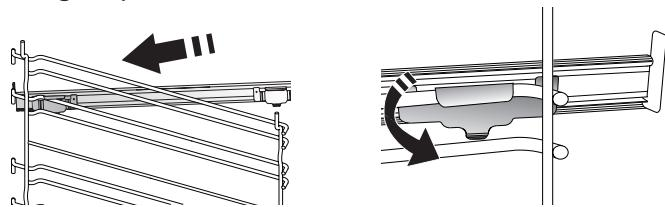
Nota: Las guías deslizantes se pueden montar en cualquier nivel.
