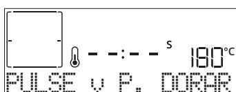
Cuando la pantalla lo indique, si lo desea pulse ✓ para iniciar un ciclo de gratinado de cinco minutos. Puede detener la función en cualquier momento pulsando ⓧ para apagar el horno.
