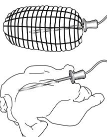
Introduza a sonda de temperatura no interior da carne, evitando ossos e zonas de gordura. Tratando-se de aves, insira o termómetro no sentido do comprimento, no centro do peito, evitando as cavidades.
