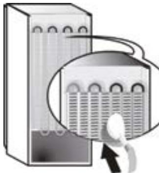
Kako biste osigurali stalan i ispravan protok vode odleđivanja, redovito čistite unutrašnjost ispusta na stražnjem dijelu hladnjaka u blizini ladice za voće i povrće pomoću isporučenog alata.
