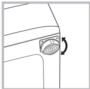
2. Якщо підлога не є ідеально горизонтальною, компенсуйте нерівності за допомогою передніх ніжок (див. малюнок) – розкручуючи чи закручуючи їх; кут нахилу
