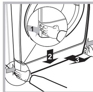
1. зніміть захисну панель з передньої частини машини шляхом натискання у центрі, потім натисніть униз з обох боків та витягніть її (див. малюнок).
