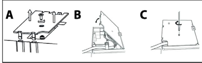
**ВНИМАНИЕ:** Кабель электропитания должен иметь достаточную длину для того, чтобы варочная панель могла быть снята со столешницы. При этом кабель должен быть размещен так, чтобы избежать его повреждения или перегрева из-за соприкосновения с основанием.
