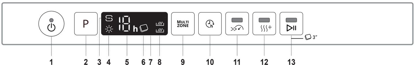
1. Ein-Aus/Reset Taste mit Anzeigelicht
