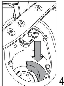
Nakon što se očiste filteri treba ih opet smestiti na svoje mesto, obraćajući pažnju da budu pravilno postavljeni. To će omogućiti održavanje nivoa efikasnosti mašine.
