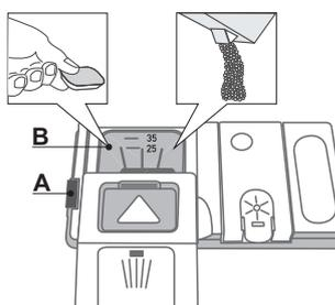
**Za otvaranje dozatora detergenta koristi se funkcija A. Detergentom se može puniti isključivo suvi dozator B. Detergent za pripremno pranje sipa se direktno u unutrašnjost komore.**
