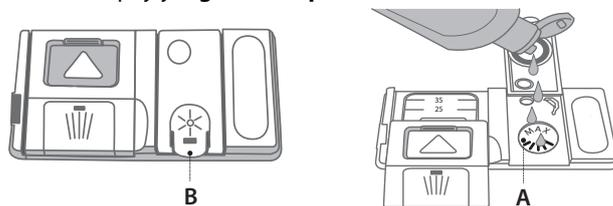
1. Zatim molimo da otvorite dozator **B**, pritiskajući i vukući taster na poklopcu.
