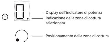
Posizionare la pentola sulla zona di cottura desiderata. Accendere il piano cottura, quindi attivare la zona di cottura prescelta premendo il corrispondente tasto di posizione. Sul display viene visualizzato "0". È possibile selezionare il livello di
