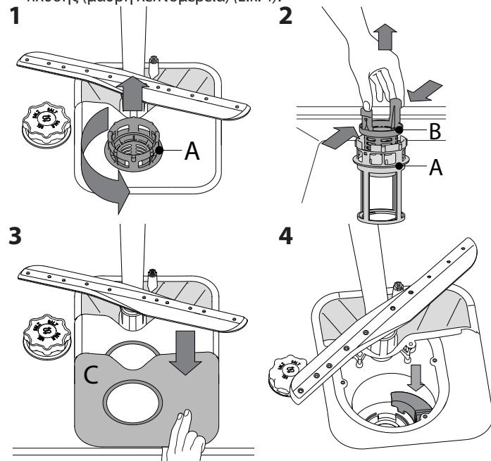
Μετά τον καθαρισμό των φίλτρων, επαναποθετήστε το φίλτρο και στερεώστε το καλά στη θέση του. Αυτό είναι σημαντικό για να διατηρείται η αποτελεσματική λειτουργία του πλυντηρίου πιάτων.
