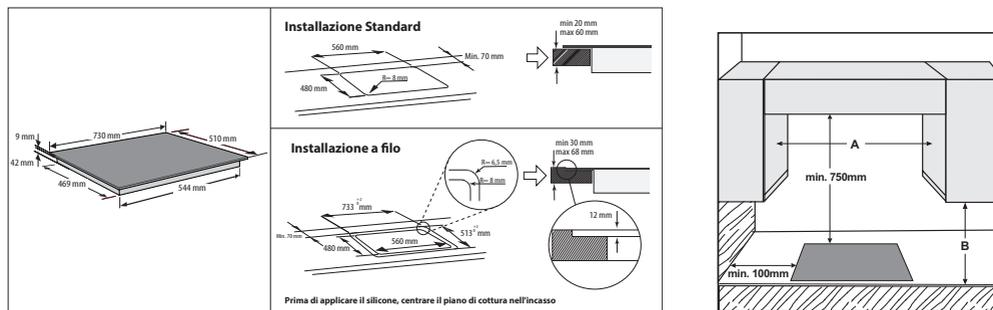
**NOTA:** se la distanza "A" tra i pensili è compresa tra 600 mm e 730 mm, l'altezza "B" deve essere minimo 530 mm. Se la distanza "A" tra i pensili è maggiore della larghezza del piano di cottura, l'altezza "B" deve essere minimo 400 mm. Qualora venga installata una cappa sopra il piano di cottura, fare riferimento alle istruzioni di montaggio della cappa per la distanza da rispettare
