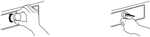
Anschließend können Sie die Wasserhärteeinstellung Ihrer Waschmaschine Ihrer örtlichen Wasserhärte anpassen. Dies wird empfohlen, um die Dosieranzeigefunktion zu optimieren. Drehen Sie den Knopf, um zwischen weich / mittel / hart zu wählen und bestätigen Sie durch Drücken des Knopfes.
