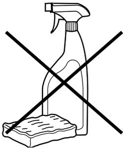
Verwenden Sie keine Glas- oder Allzweckreiniger, Scheuermittel oder ähnliches, um die Bedientafel zu reinigen – diese Stoffe könnten die Bedruckung beschädigen.
