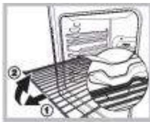
**XƏBƏRDARLIQ!** Soba stop sistemi ilə təchiz olunub, bu sistem qəfəsələrin qəflətən çıxmasına mane olur. (1) Şəkildə göstərilən kimi, qəfəsələri tam çıxartmaq üçün onları qabaq hissəsindən tutub, azca qaldırıb çıxarmaq (2) mümkündür.
