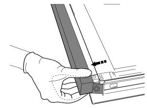
**2.** Ridicați și țineți ferm cu ambele mâini geamul interior, demontați-l și amplasați-l pe o suprafață moale înainte de a-l curăța.
