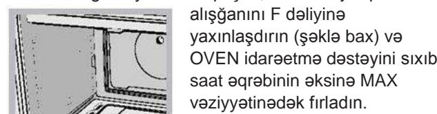
alışqanını F dəliyinə yaxınlaşdırın (şəklin bax) və OVEN idarəetmə dəstəyini sıxıb saat əqrəbinin eksinə MAX vəziyyətinədək fırladın.
