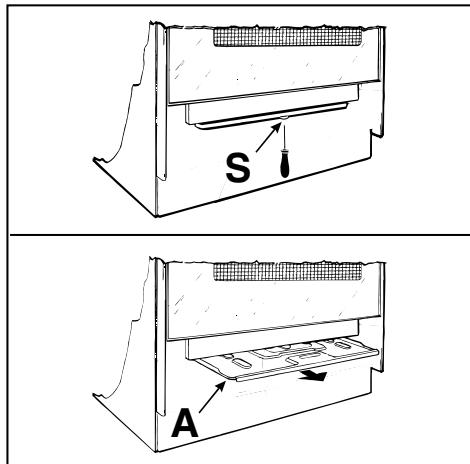
Pentru a scoate tabla de protecție „A” din aluminiu, deșurubați șurubul „S”. La încheierea operației, puneti la loc tabla de protecție și fixați-o cu șurubul „S”. Înainte de a utiliza cuptorul, verificați dacă tava de protecție „A” este fixată în poziția corectă
