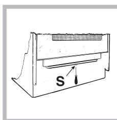
До використання духовки перевірте, щоб висувний захист був правильно закріплений.
