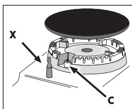
Якщо плита обладнана електророзпалюванням\* (С), спочатку натисніть на кнопку включення, відмічену символом **★**, потім натисніть до упору і одночасно обертаєте проти годинникової стрілки рукоятку ПАЛЬНИКА до позначки максимального полум'я, аж доки не з'виться полум'я.
