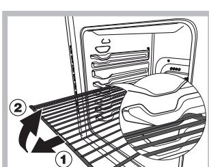
УВАГА! Духовка оснащена системою зупинення решіток, завдяки якій можна вийняти їх так, щоб вони не випадали з духовки(1). Щоб повністю вийняти прешітки, достатньо, як показано на малюнку, підняти їх, взятися спереду і витягнути (2).
