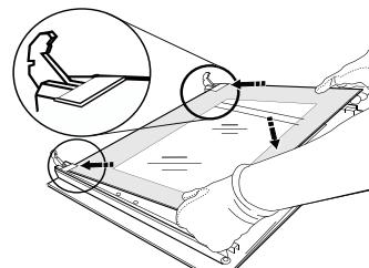
**4.** Montați la loc marginea superioară: Poziționarea corectă se realizează după ce se audă un clic. Asigurați-vă că garnitura este fixată sigur înainte de a remonta ușa.
