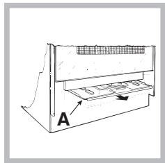
Щоб видалити висувний захист відгвинтіть гвинт S (див. малюнок). Для монтажу заблокуйте його за допомогою гвинта S.
