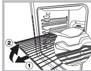
ATENȚIE!Cuptorul este prevăzut cu un sistem de oprire a grătarelor care permite extragerea acestora fără ca ele să iasă din cupor(1). Pentru a extrage complet grătarele este suficient, astfel cum se arată în desen, să le ridicați, prințându-le din partea din față și să le trageți (2).
