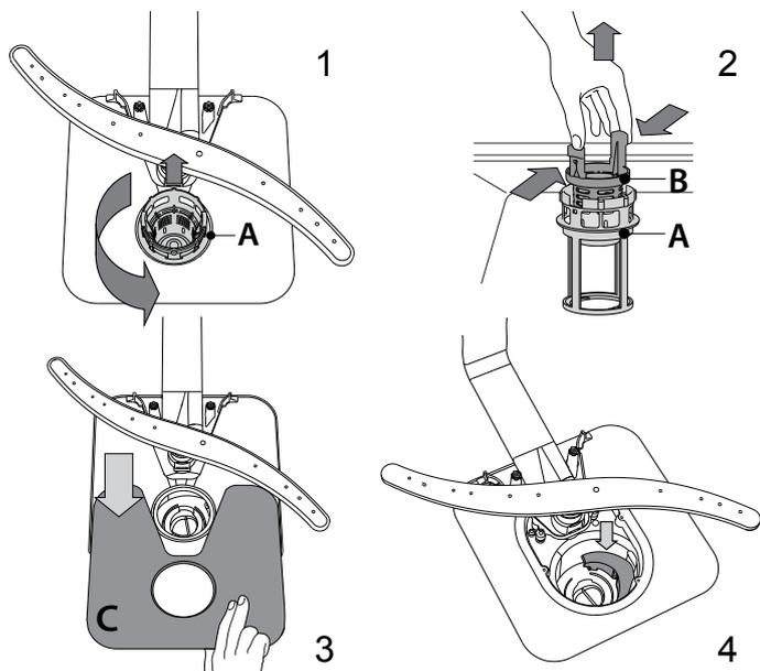
Depois de limpar os filtros, volte a colocar o conjunto de filtros e fixe-o corretamente na devida posição; isto é essencial para manter um funcionamento eficaz da máquina de lavar loiça.
